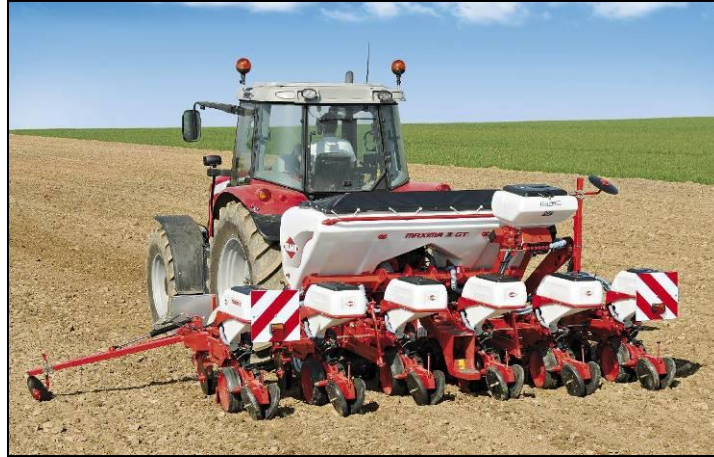
KUHN MAXIMA 6 soros szemenkéntvető gép
