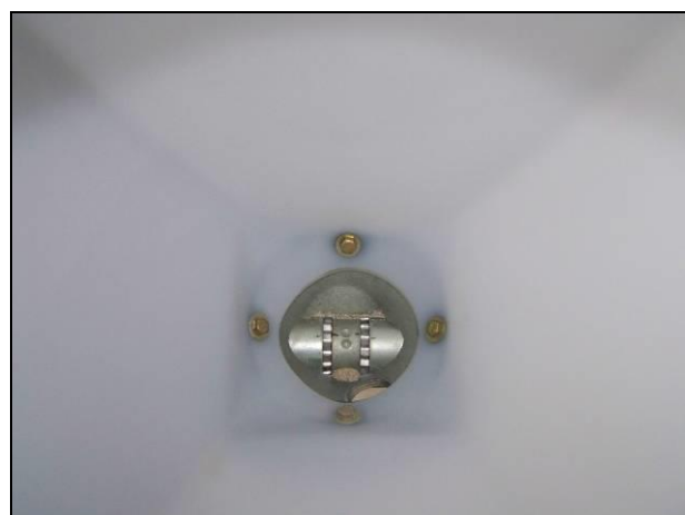
Granulátum adagoló tengely (6mm széles, 18 fogú celláskerekekkel)
